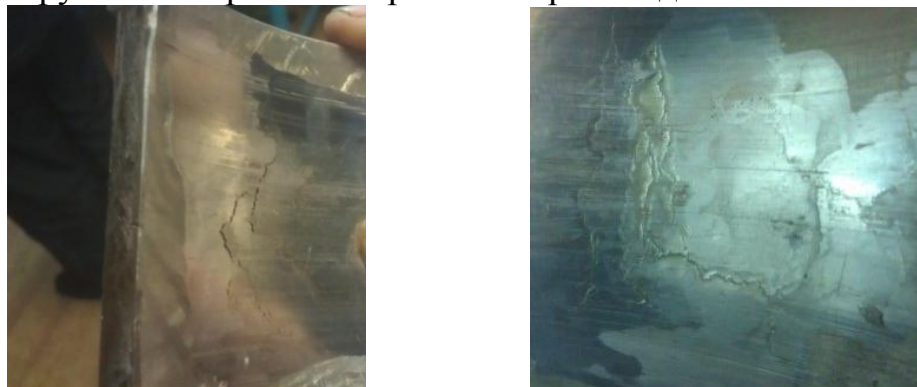
Рис. 1. Дефекты антифрикционного баббитового слоя
